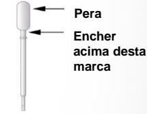
\*Pipeta de transferência do ensaio HCV VL
